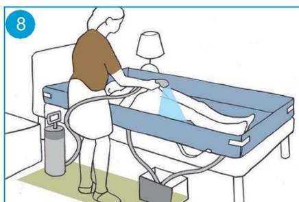
El sistema cuenta con varios puntos de drenaje de agua y mangueras rectas o curvas que facilitan esta operación. El agua se puede traer desde un grifo con una extensión, o se puede usar el tanque de agua a presión (accesorio opcional). Para uso profesional en instalaciones residenciales o de rehabilitación, se sugiere utilizar sábanas desechables que se puedan usar para cada lavado.
