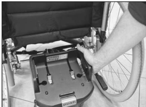
Pase la barra telescópica a través del extremo delantero del sistema V-drive. Afloje el fijador de tres puntas de la barra y ajústela a la longitud correcta. Apriete los fijadores en la barra y en la parte delantera del sistema V-drive. Coloque los dos extremos de la barra en la parte trasera de los soportes y, a continuación, empuje el sistema V-drive hacia delante hasta que quede bloqueado.
